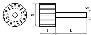
Die angegebenen höchstzulässigen Drehzahlen gelten für eine maximale offene Schaftlänge  $L_0$  von 20 mm. Für andere Ausraglängen muss die höchstzulässige Drehzahl gesondert errechnet werden!
