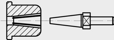
Das Spannsystem für Polierscheiben, bestehend aus einer Kunststoffbüchse (MCA) und dem Aufspanndorn mit Schaft 8 mm (K25), der Form SE1 ist ausschließlich für die Abmessungen 10010 B.25 und 10020 B.25 einsetzbar. Polierscheiben größeren Durchmessers dürfen mit diesem System nicht eingesetzt werden. Die höchstzulässige Schnittgeschwindigkeit für dieses Spannsystem beträgt 10 m/s. Dies entspricht bei einem Scheibendurchmesser von 100 mm maximal 1.900 1/min.
