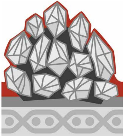
Das Kompaktkorn (CG) besteht aus vielen Schleifkörnern und schleifaktivem Füllstoff, die vor dem Einbringen in das Werkzeug miteinander verklebt werden. Während des Schleifens brechen einzelne abgenutzte Partikel aus dem Kompaktkorn heraus und machen so Platz für tieferliegende Schleifkörner mit neuen, scharfen Schneiden. Dadurch setzen sich Werkzeuge mit Kompaktkorn auch bei weichen oder schmierenden Materialien nicht zu.
