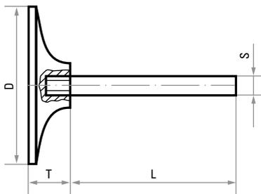
Die angegebenen höchstzulässigen Drehzahlen gelten für eine maximale offene Schaftlänge  $L_0$  von 20 mm. Für andere Auskraglängen muss die höchstzulässige Drehzahl gesondert errechnet werden!
