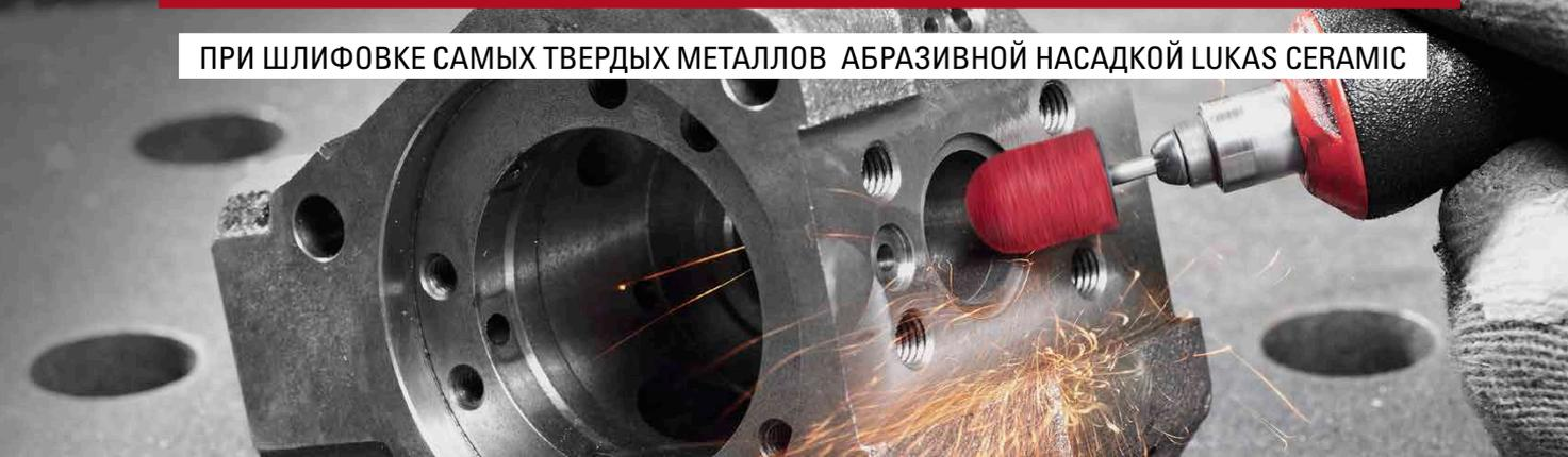
Будь то инструментальная сталь, стальное литье или титановые сплавы, — в сфере промышленности постоянно возрастает объем обработки исключительно твердых и прочных металлов. Благодаря керамической абразивной насадке — инструменту для прямошлифовальных машин — сейчас обработка мелких деталей и зачистка стали максимально легкими. Очень долгий срок службы инструмента — дополнительный бонус благодаря эффекту самозатачивания.
