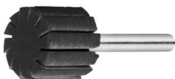
Der Schleifbandträger STZY dient der Aufnahme (Spannung) von zylindrischen LUKAS-Schleifbändern wie z. B. dem Schleifband SBZY mit Zirkonkorund oder Normalkorund. Durch die besondere Schlitzung des Trägers werden die Schleifbänder auch bei zunehmender Drehzahl sicher gespannt und halten fest am Träger.
